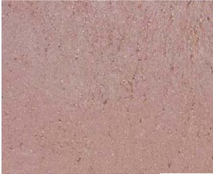
Rot eingefärbter Beton
